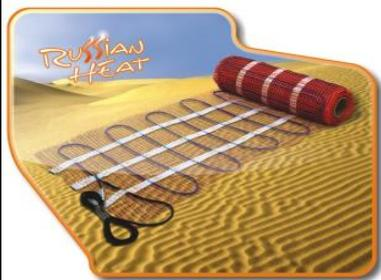
Конструкция теплого мата RUSSIAN HEAT представляет из себя двухжильный экранированный кабель, нагревающийся за счет высокого сопротивления материала из которого он изготовлен толщиной 4,22 мм, смонтированный на полихлорвиниловой сетке шириной 500 мм, с фиксированным шагом укладки. Температура пола поддерживается с помощью терморегулятора с выносным датчиком температуры (приобретается отдельно).
